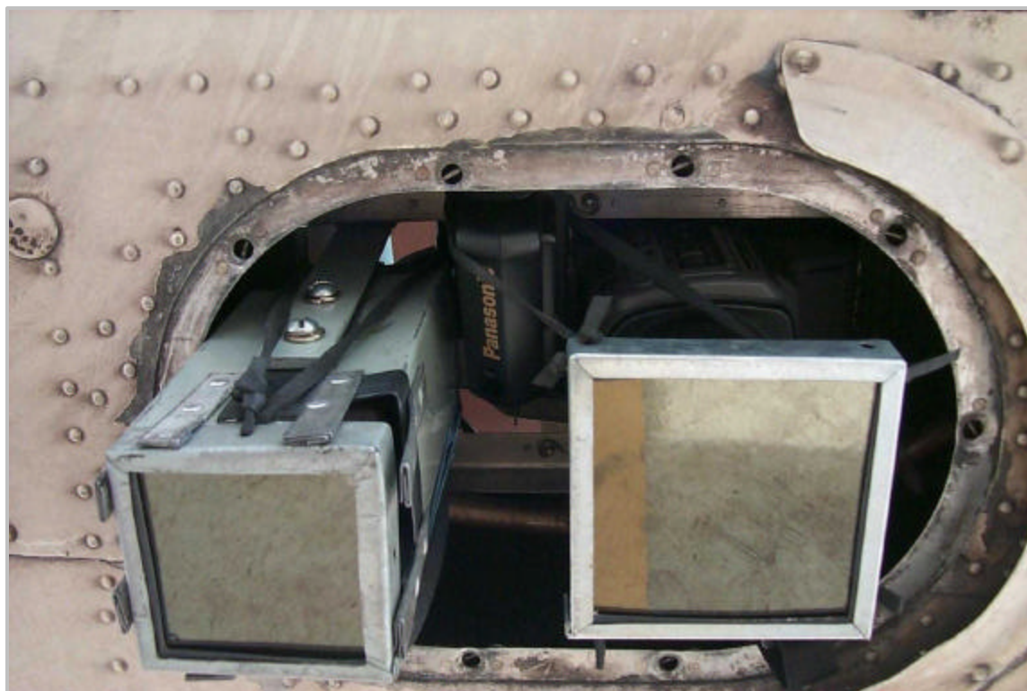
Figura 7 - Detalhe da fixação dos filtros de subtração nas câmeras instaladas no avião.
