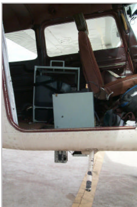
Figura 4 - Fixação das câmeras no piso do avião.
