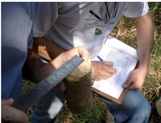
**Figura 14: Medição do diâmetro de uma amostra do fuste para determinação posterior do teor de casca e da biomassa**
