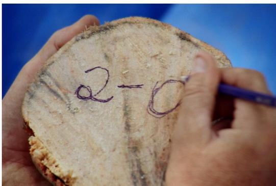
**Figura 15: Identificação de cada amostra retirada do fuste, indicando árvore e posição da amostra nas árvores, e o acondicionamento final das amostras para determinação do teor de umidade**
