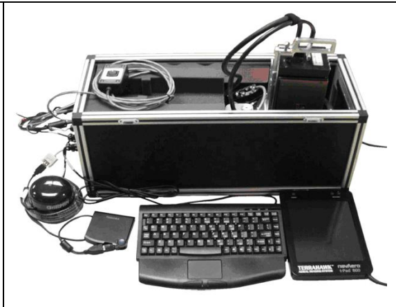
Figura 4.2.2-5. Imagem dos equipamentos que compõem o sistema de videografia. Elaborado pelo autor.
