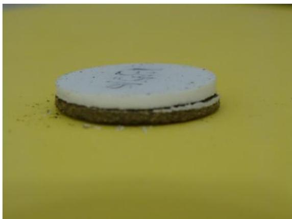
Figura 9 - Pastilha prensada de dupla camada
