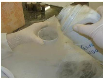
Figura 8 - Método de moagem com nitrogênio líquido
