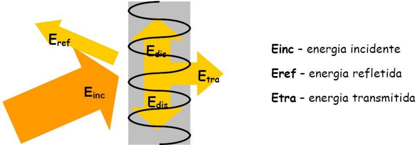
A absorção sonora consiste em reduzir ao máximo a reflexão da energia sonora que incide sobre uma superfície. A energia absorvida é parcialmente dissipada (como energia térmica) e parcialmente transmitida.
