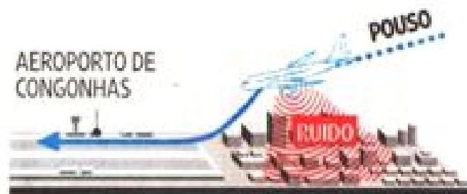
>> O ruído é alto durante o pouso do avião pois os motores estão mais próximos do solo e na decolagem, quando o avião acelera seus motores para ganhar força para decolar e continua em baixa altitude
