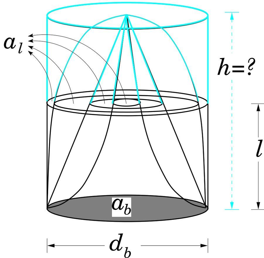
Figura B.1: Representação dos toretes do tronco de uma árvore através sólidos geométricos truncados. A altura total do sólido ( $h$ ) é sempre desconhecida, mas é possível se medir o comprimento do torete ( $l$ ) e obter as áreas das duas faces do torete (base:  $a_b$  e topo:  $a_l$ ) medindo-se os diâmetros.
