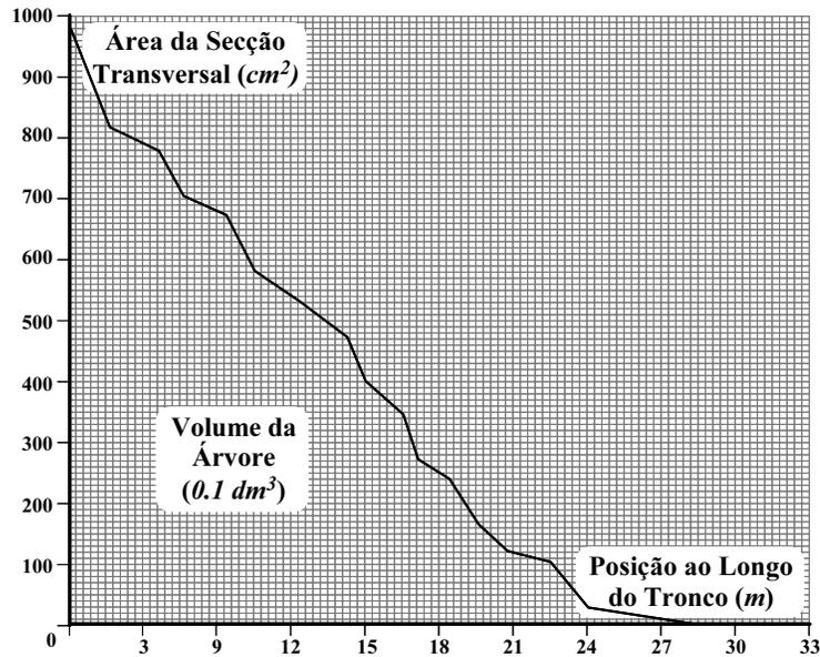
Figura 5.7: Cubagem de árvore inteira utilizando o método gráfico. No eixo das ordenadas ( $y$ ) coloca-se a área seccional obtida em diferentes posições do tronco. No eixo das abcissas ( $x$ ) coloca-se a distância a partir da base do tronco. O volume da árvore é definido como a área abaixo da linha do gráfico. As áreas seccionais devem ser plotadas em  $\text{cm}^2$  e a distância da base em m, assim, a unidade de medida do volume é  $0.1 \text{ dm}^3$ .
