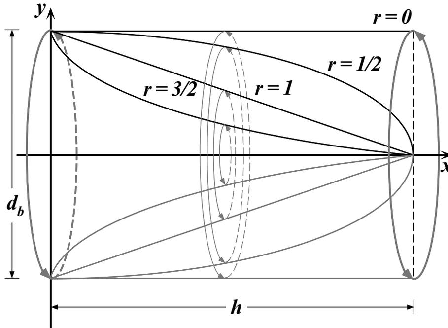
Figura 5.4: Formação dos sólidos geométricos da família do cilindro a partir da rotação de uma função no plano cartesiano  $x-y$  que represente a variação do raio ( $y$ ) em função da altura ( $x$ ) a partir da base. Duas medidas dos sólidos permanecem inalteradas: o diâmetro da base ( $d_b$ ) e a altura total ( $h$ ).
