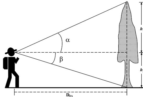
Figura 4.7: Funcionamento do método trigonométrico de medição de altura. Para as visadas de topo e base da árvore o instrumento mede o ângulo. Com o conhecimento da distância do observador à árvore e da tangente dos ângulos medidos, a altura da árvore é determinada.
