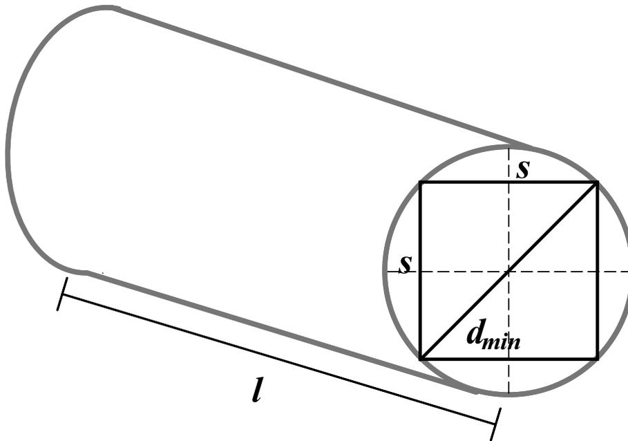
Figura 5.8: Método da Alfândega de Paris para a quantificação do volume útil para serraria em madeira roliça. O volume útil é definido como o sólido geométrico de *base quadrada* a partir do quadrado circunscrito na face de menor diâmetro da tora:  $s$  é o lado da base quadrada,  $d_{\text{MIN}}$  é o diâmetro da tora na sua menor face, sendo também a diagonal da base quadrada, e  $l$  o comprimento da tora.
