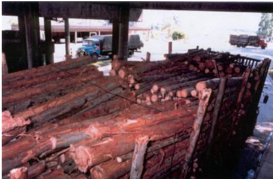
Figura 8: Carga com empilhamento longitudinal com uma “gaiola” em forma de “V”. Propositadamente, as toras foram empilhadas com maior altura nas bordas da carceria gerando um grande espaço vazio no meio da carga.
