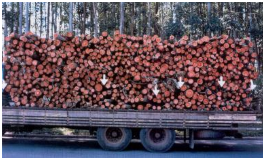
Figura 6: Vista da carroceria de um caminhão com várias “gaiolas” ocasionadas pelo mau empilhamento.
