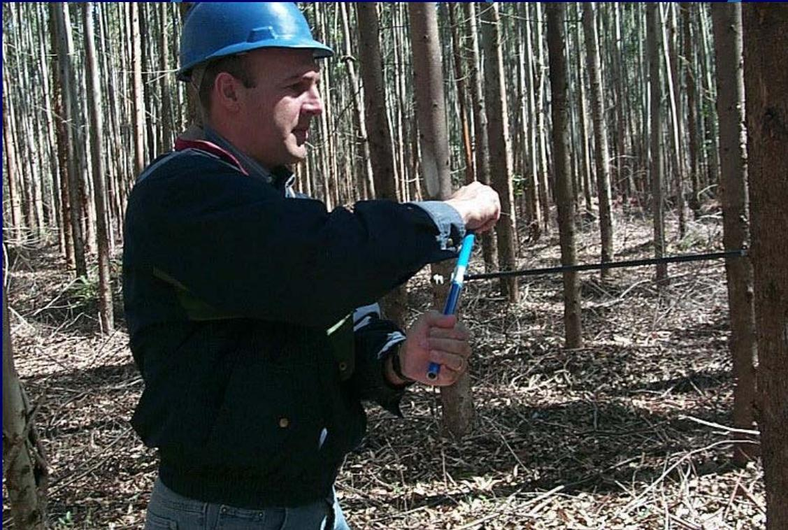
Retirada de uma amostra de madeira para análise da densidade básica (sonda Pressler)
