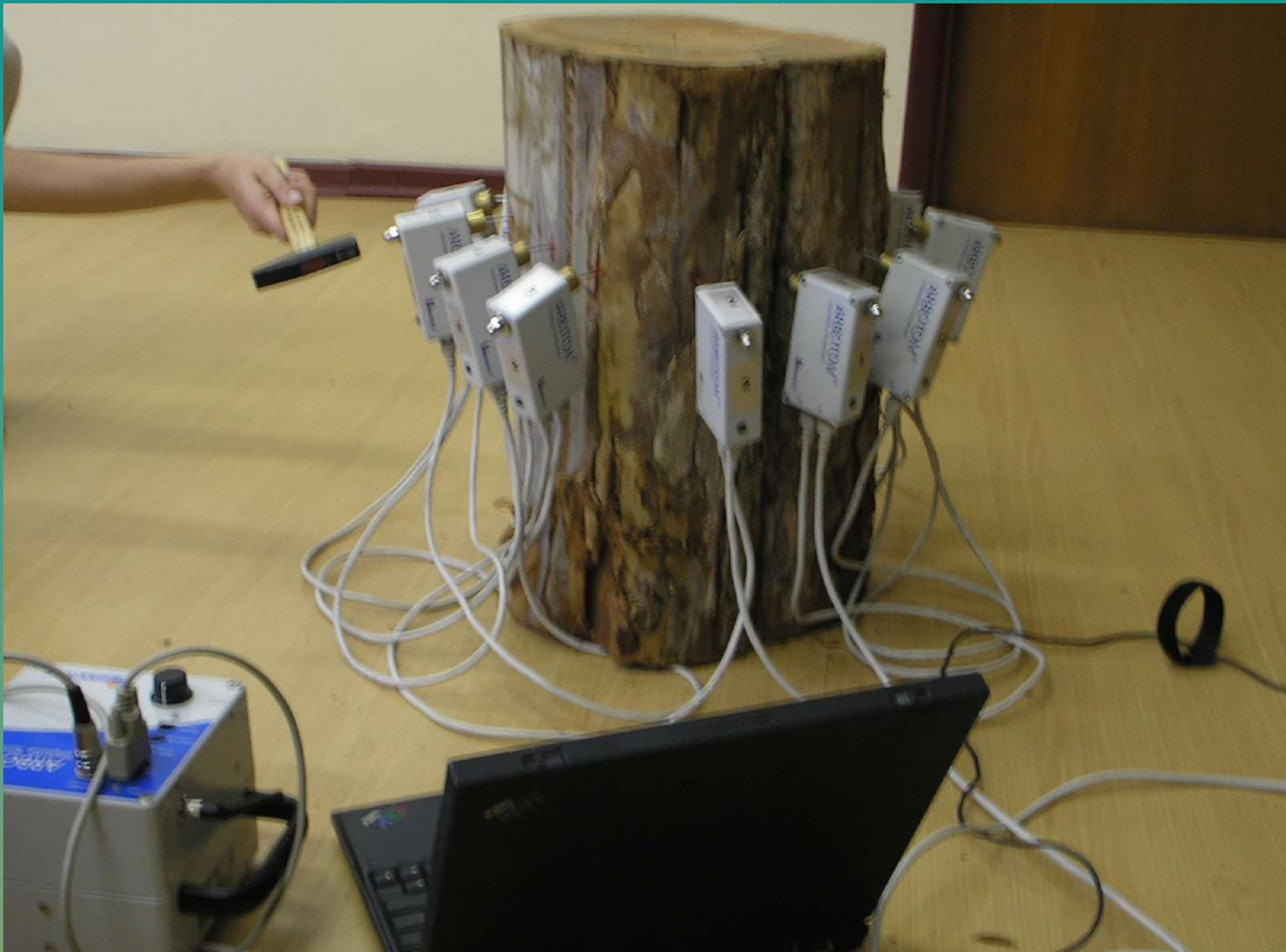
Figura 2. Aplicação do Tomógrafo de impulso.
