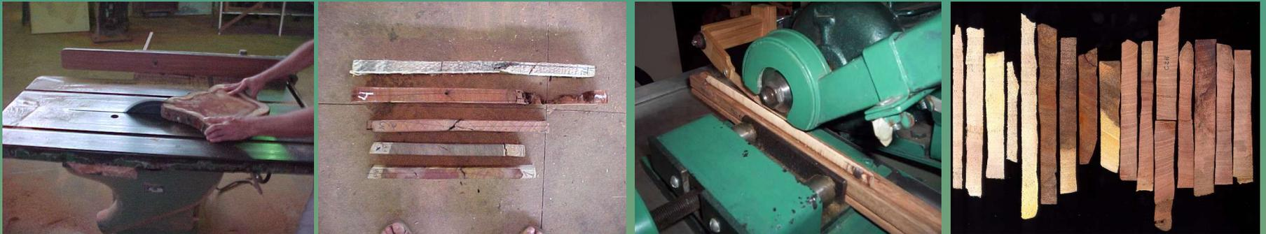
Figura 4. Obtenção de amostra de diâmetro para densitometria de raio X.
