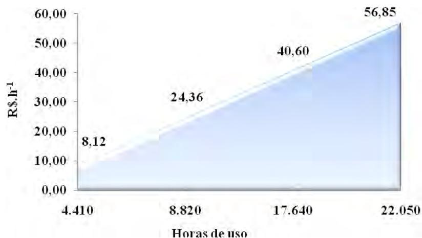
Figura 20: Simulação dos custos de reparos e manutenção do *Harvester*.
