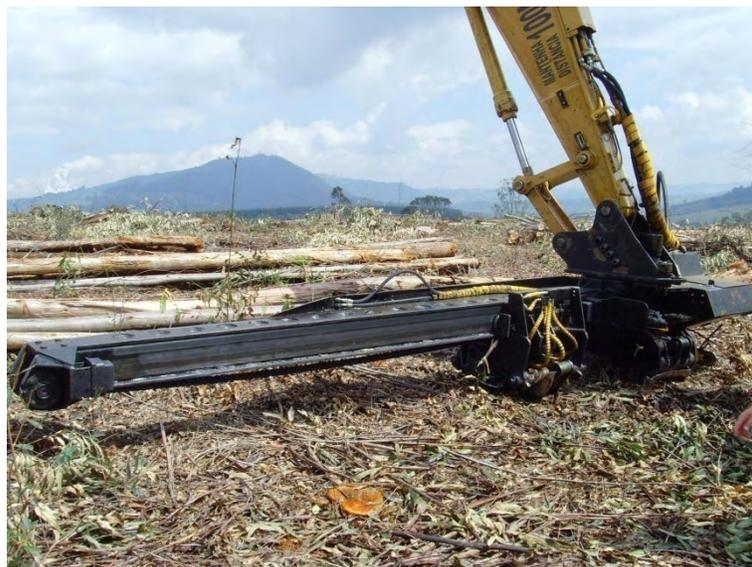
Figura 11: Cabeçote Processador Florestal da marca MSU.
