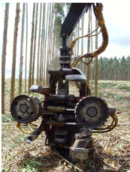
Figura 7: Cabeçote *Harvester* da marca *Valmet*.
