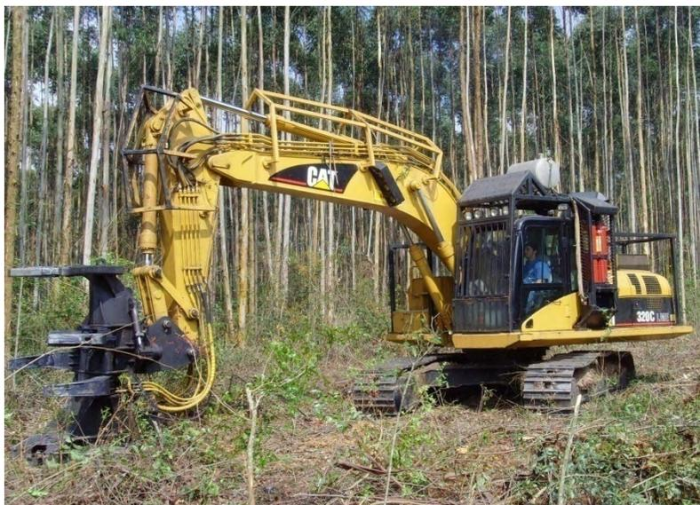
Figura 8: Máquina base *Caterpillar* 320 CL equipada com o cabeçote *Feller-Buncher*.
