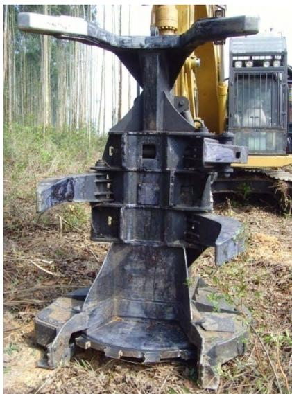
Figura 9: Cabeçote *Feller-Buncher* da marca *Risley*.
