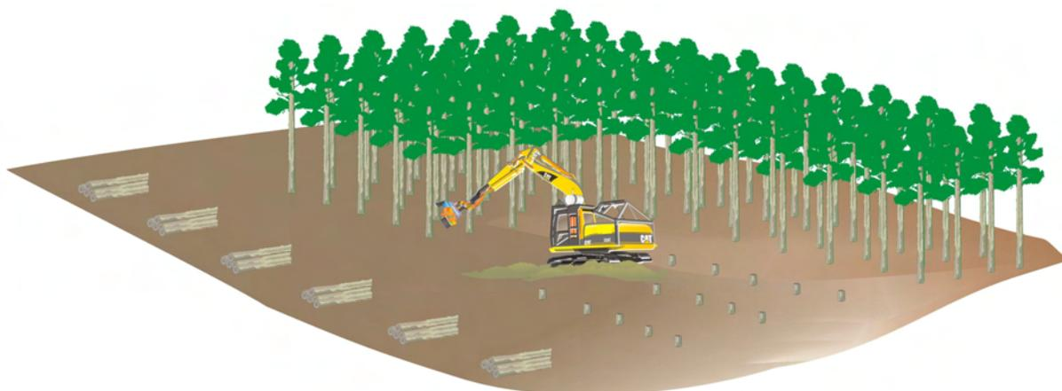
Figura 3: Deslocamento do *Harvester* no eito de derrubada.
